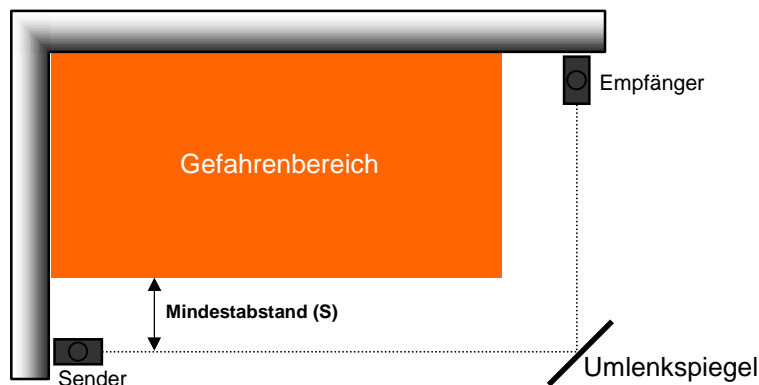
Abbildung 4: Beispiel für eine Zugangsabsicherung
